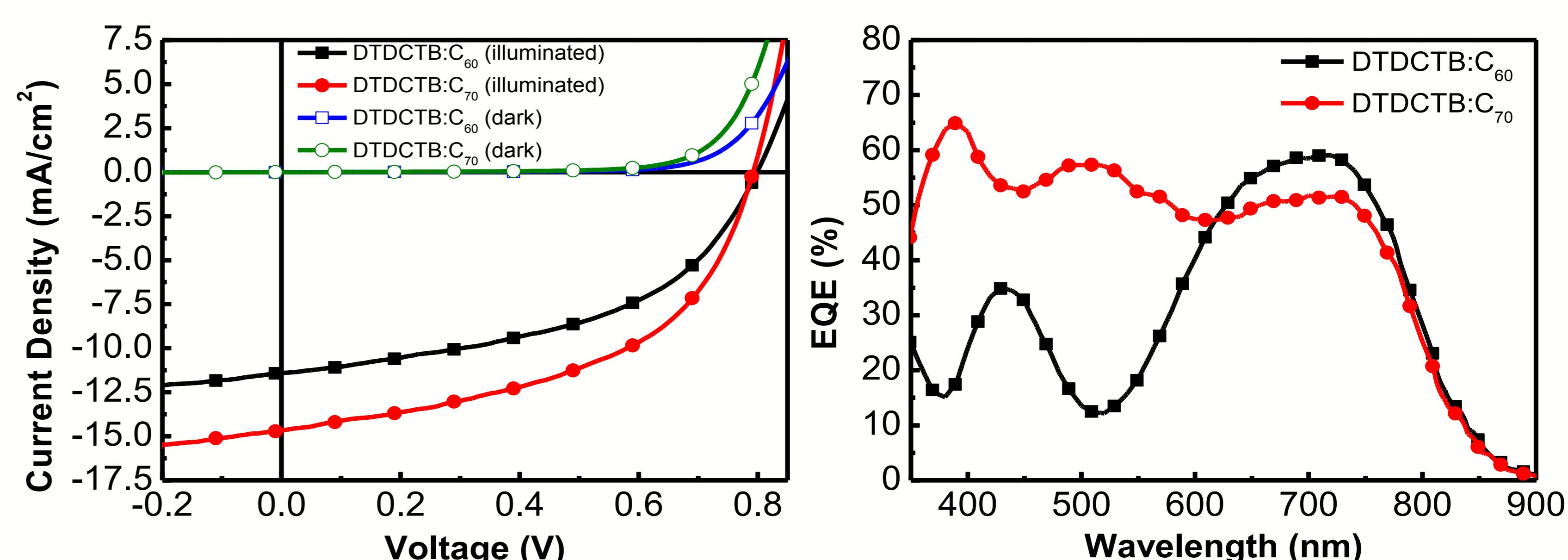
Device Structure : ITO/ $MoO_3$  (5 or 30 nm)/**DTDCTB** (7 nm)/1:1 (v/v) **DTDCTB:C<sub>60</sub>** or **DTDCTB:C<sub>70</sub>** (40 nm)/ $C_{60}$  (20 nm) or  $C_{70}$  (7 nm)/BCP (10 nm)/Ag (150 nm).
