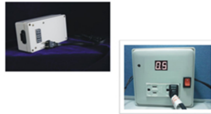
(圖六 無線電力監控系統主機外觀照片)
