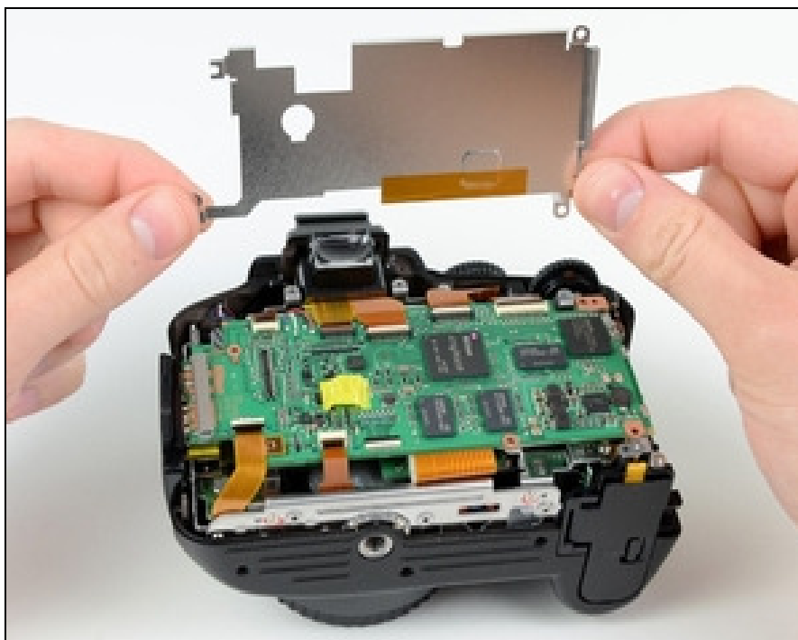
圖 3-8：數位相機電路板及液晶螢幕-1
