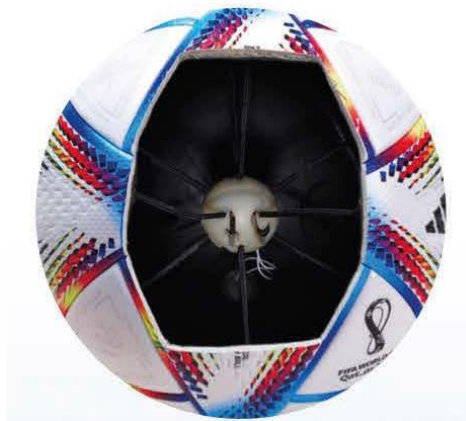
圖 2.1.4 足球球心配置有一慣性測量單元(IMU)
