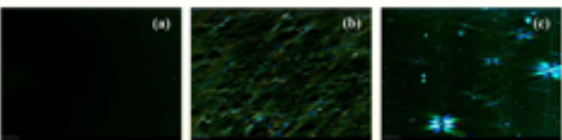
圖二 (a) A公司市售光學膜; (b) B公司市售光學膜; (c) 自製光學膜之偏光特性比較。
