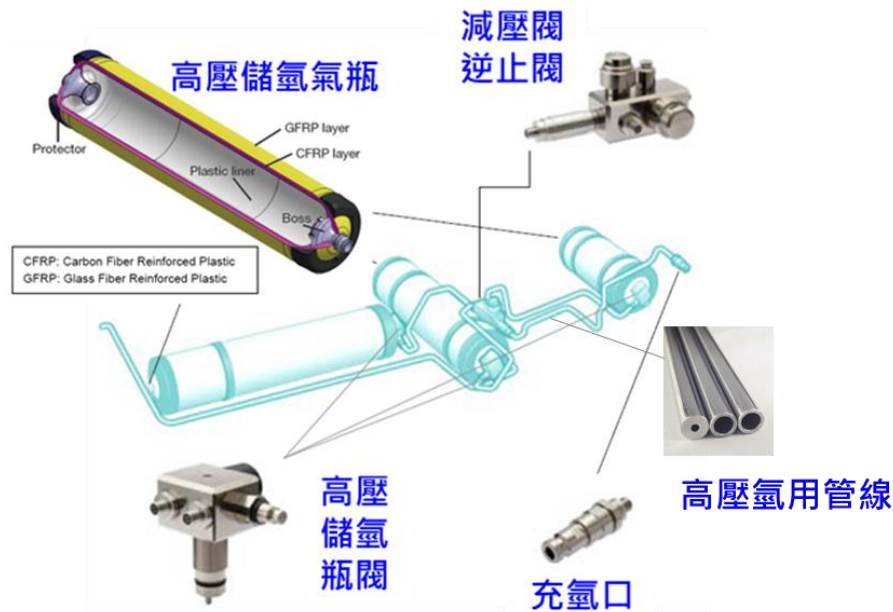
圖 2.2.12、車載儲氫系統組成
