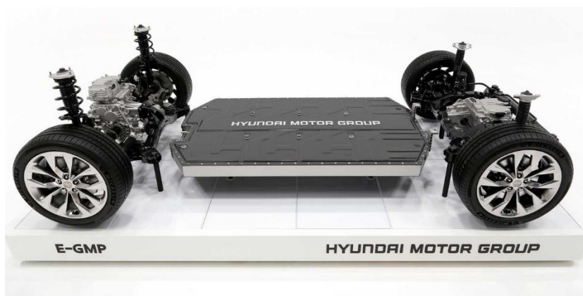
圖 2.1.4、Hyundai-KIA 集團發表全新 E-GMP 電動車模組化平台
