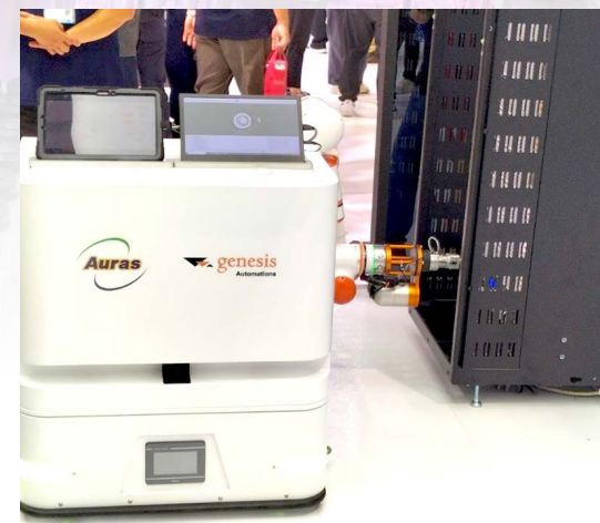
圖4、冷卻液檢測充填機器人
