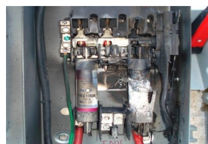
直流匯流箱的保險絲過熱或 接觸不良
