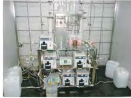
圖九 廢硫酸純化系統試驗裝置
