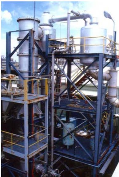
圖7、900 kWth循環式流體化床氣化爐
