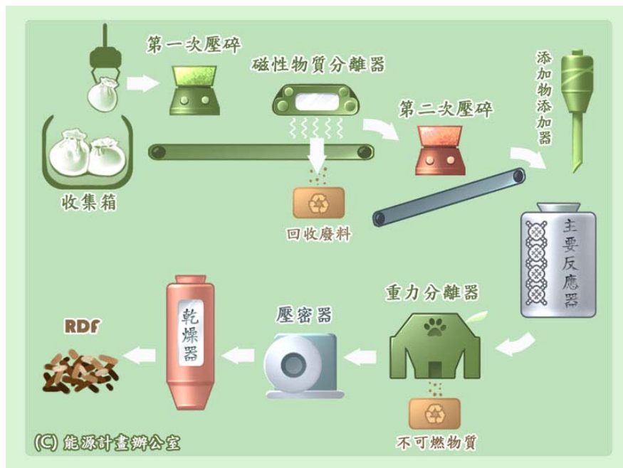
圖四 J-CATREL 製造 RDF 之程序圖
