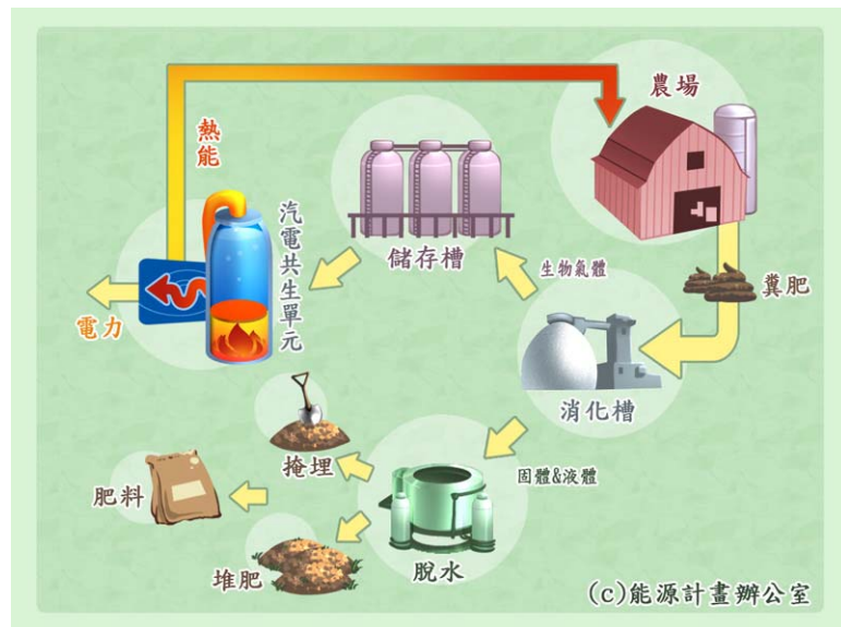
圖五 厭氧消化作業流程圖 (本研究根據參考資料[21]重製)
