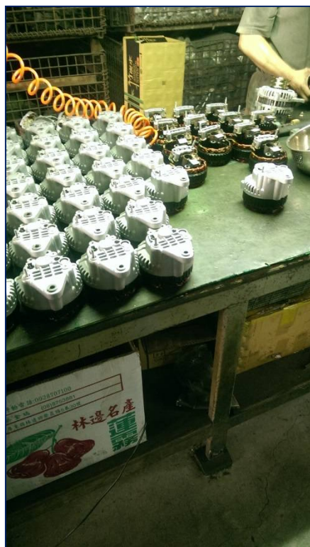
發電機翻新作業
