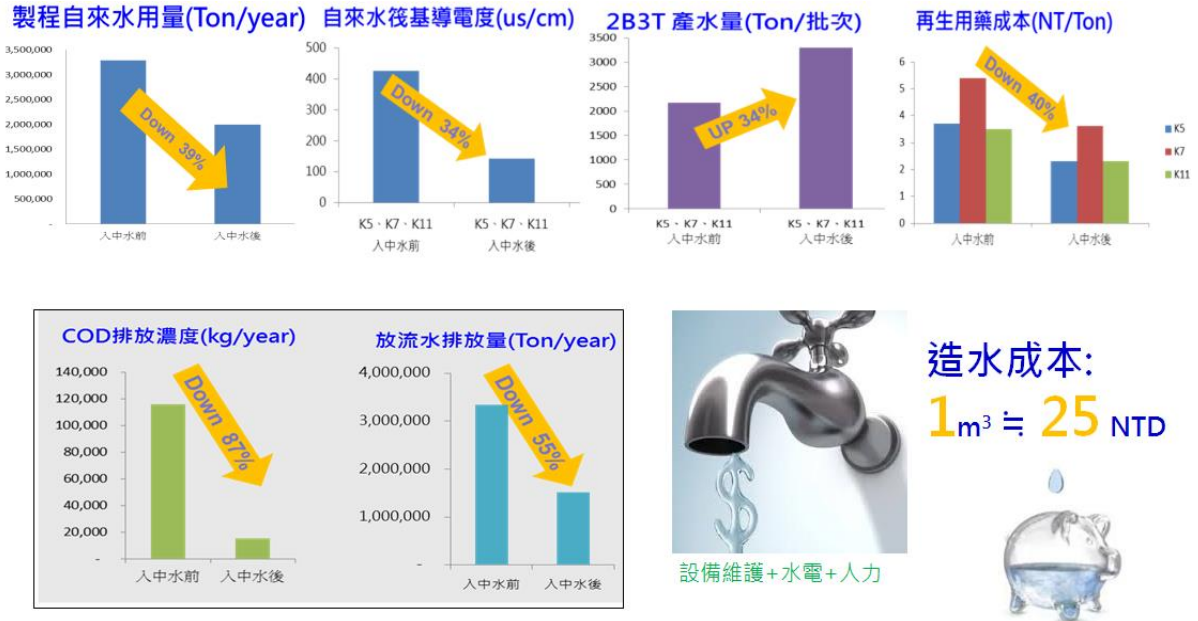
圖 7.3 日月光公司自行設置中水回收中心整體成效
