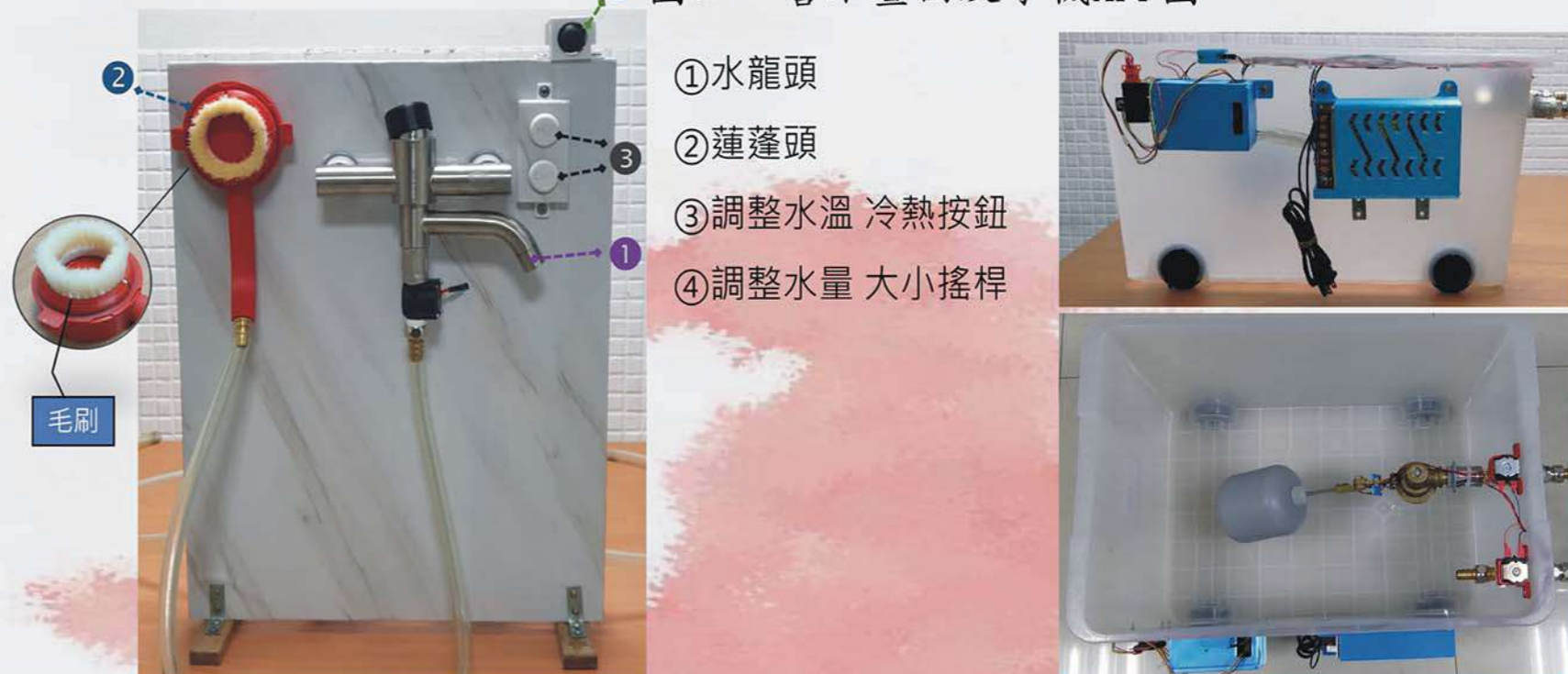
圖三 作品實體圖(左:模擬洗浴設備 右:模擬馬桶水箱)
